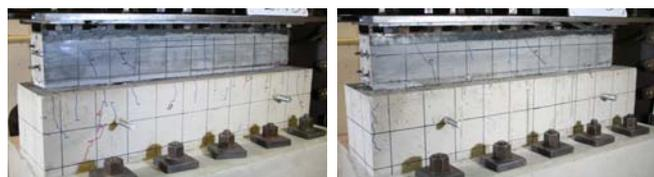
写真1 最終破壊状況
