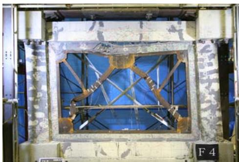
写真5 最終破壊状況(補修後再載荷)
