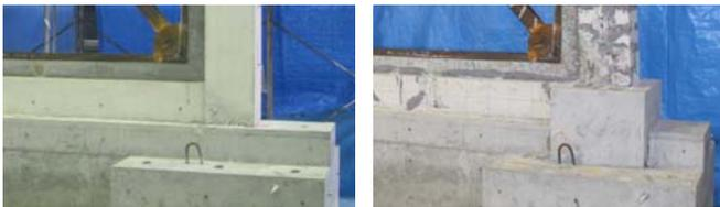
(a) 補修前 (b) 補修後
