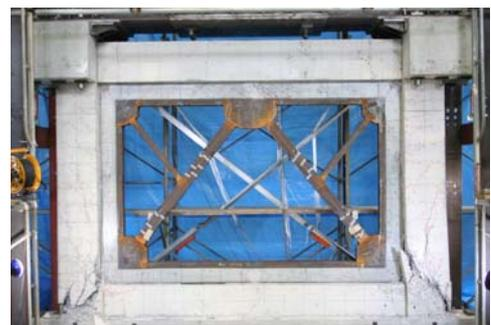
写真 3 最終破壊状況 (初期載荷)
