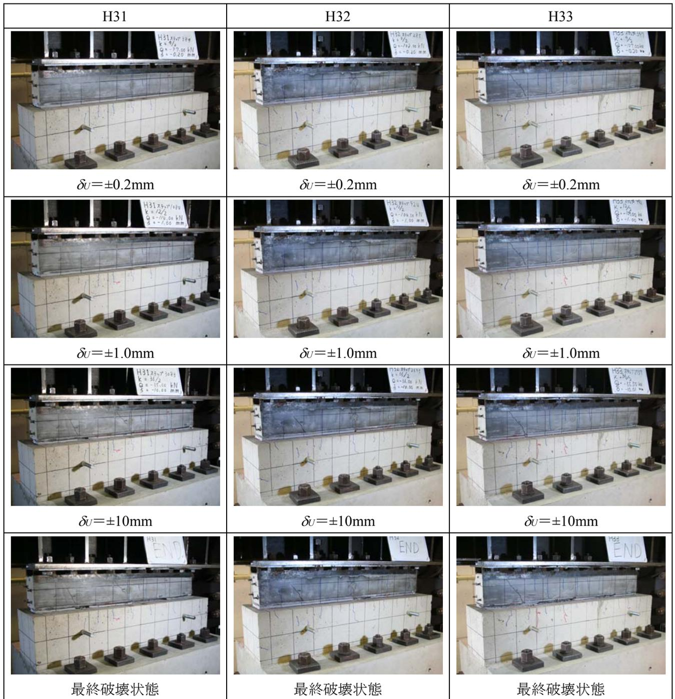
写真 2. 4-1 (b) 破壊進展状況
