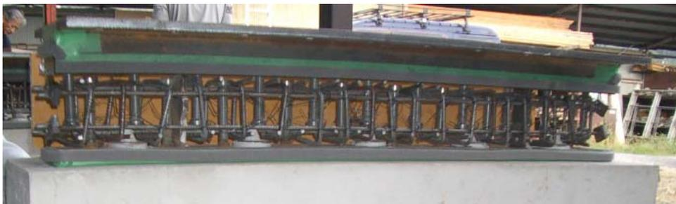
(a) アンカー筋間隔 200mm (H21, H22, H23)
