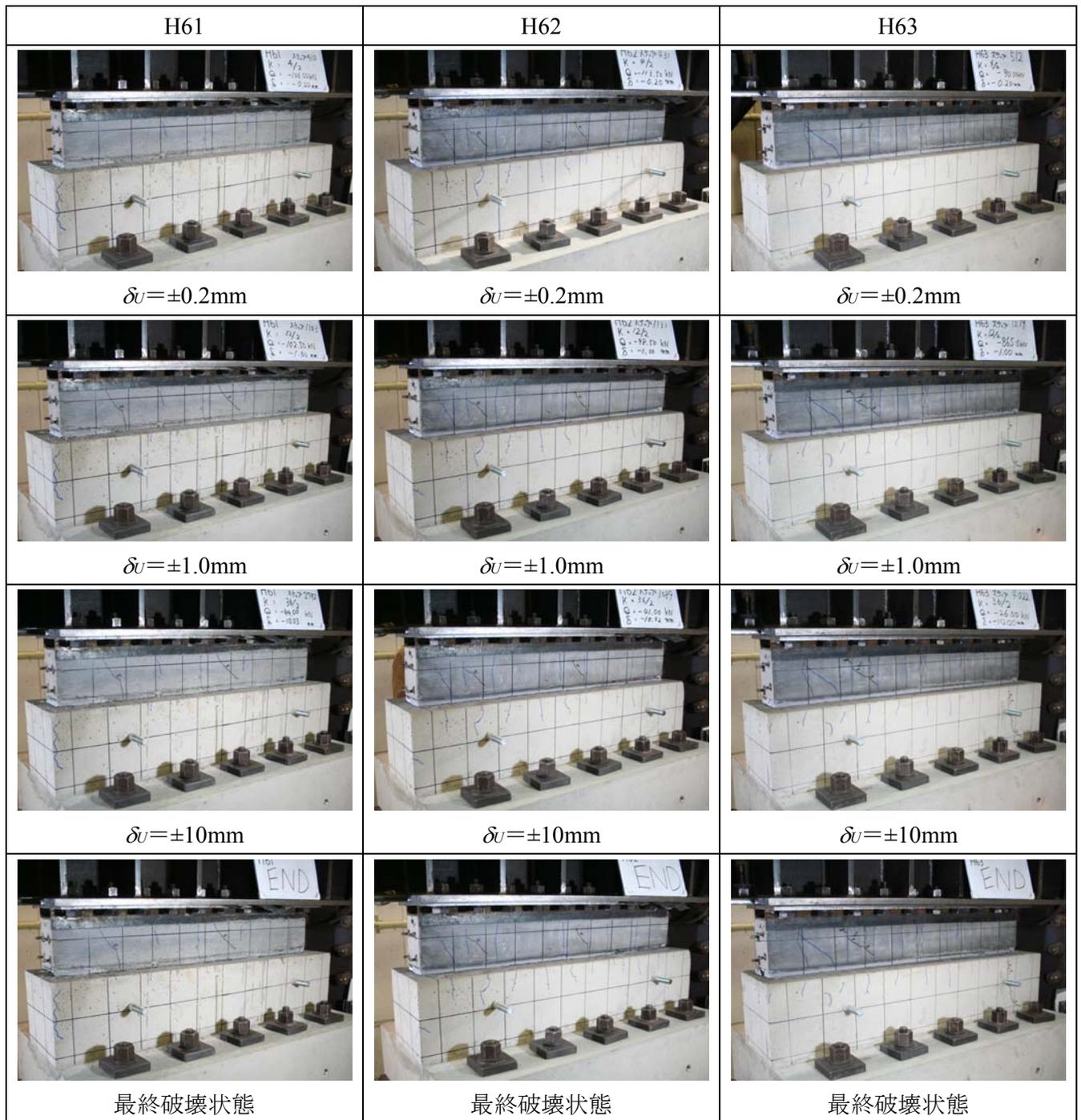
写真 2.4-1(c) 破壊進展状況
