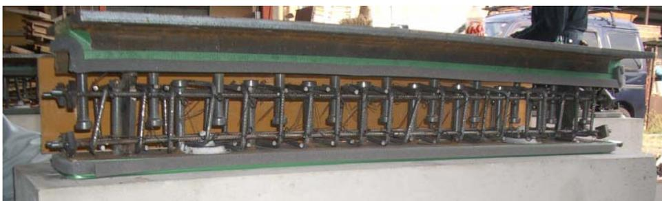
(c) アンカー筋間隔 600mm (H61, H62, H63)
