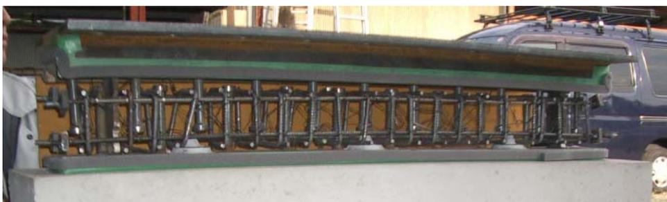
(b) アンカー筋間隔 300mm (H31, H32, H33)
