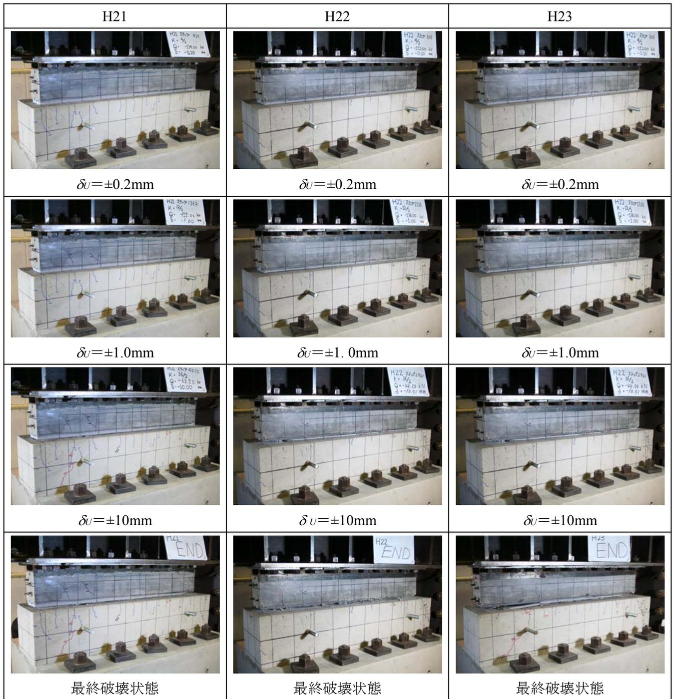
写真 2.4-1(a) 破壊進展状況
